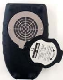
▲ベータ線検知時は背面カバーをスライドさせます
